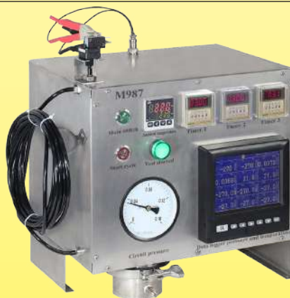
根据推动按钮的体积及其产生的压力反复不断地测量空气开关连接管的最大长度的测试设备 (Ultimheat 实验室)
